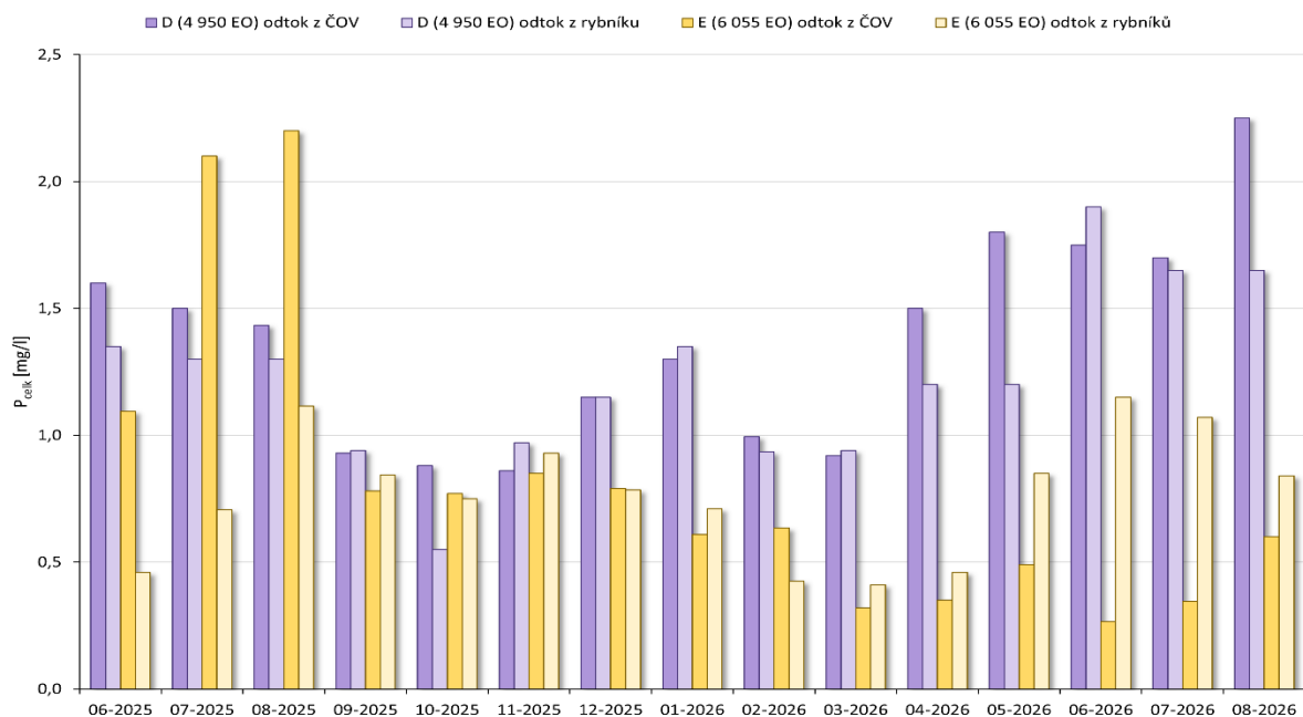
Obr. 17. Koncentrace celkového fosforu na odtoku z ČOV a za dočišťovacími rybníky Fig. 17. Total phosphorus concentrations in the WWTP effluent and downstream of the treatment ponds
