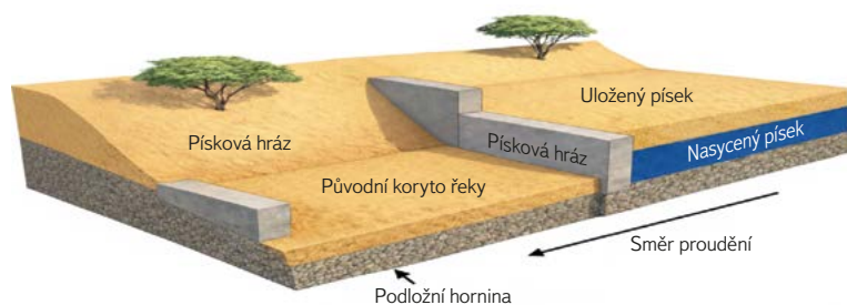
Obr. 7. Průřez systémem pískové hráze (zdroj: autoři)
