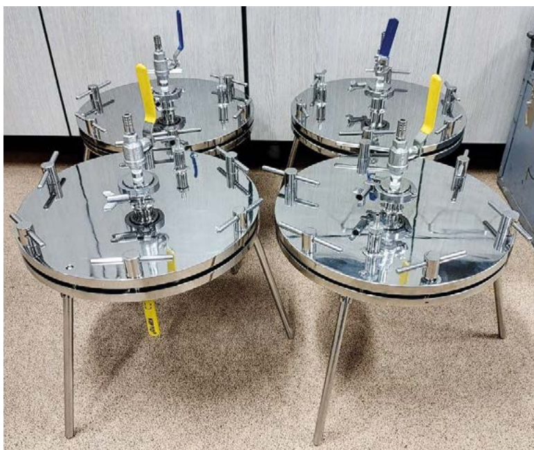
Obr. 4 a, b. Vlevo: detail filtrační aparatury; vpravo: čerpání a filtrace vody z proudnice k analýze obsahu mikroplastů
