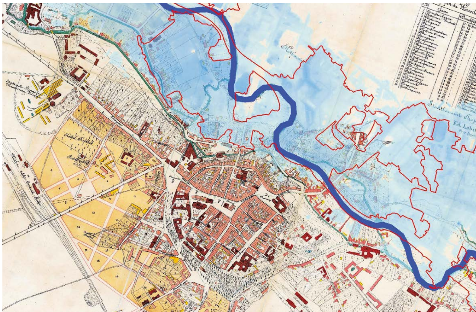
Obr. 6. Výsledek simulace hladin a záplavových území v 1D a 2D hydraulických modelech HEC-RAS a DHI MIKE pro kulminační hladinu pro průtok 438 \text{ m}^3 \cdot \text{s}^{-1} . Červená linie je hranice Q_{100} ( 388 \text{ m}^3 \cdot \text{s}^{-1} ) pro současné koryto a inundaci. Podklad tvoří Labitzkyho plán Opavy z roku 1876
