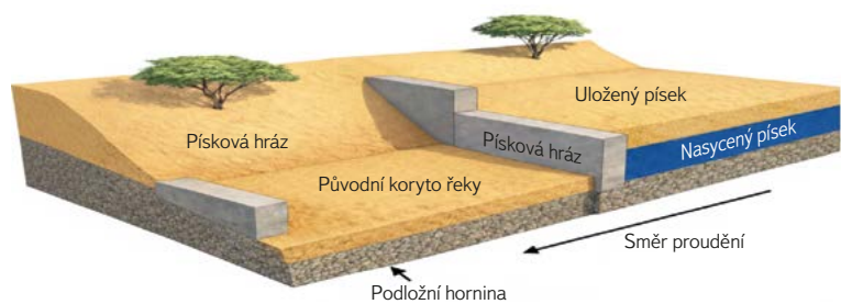
Obr. 7. Průřez systémem pískové hráze (zdroj: autoři)
