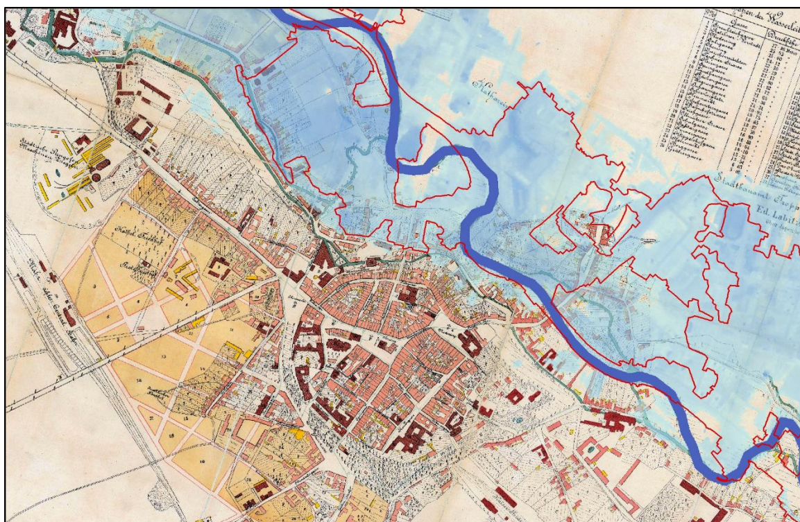
Obr. 6. Výsledek simulace hladin a záplavových území v 1D a 2D hydraulických modelech HEC-RAS a DHI MIKE pro kulminační hladinu pro průtok 438 \text{ m}^3 \cdot \text{s}^{-1} . Červená linie je hranice Q100 ( 388 \text{ m}^3 \cdot \text{s}^{-1} ) pro současné koryto a inundaci. Podklad tvoří Labitzkeho plán Opavy z roku 1876
