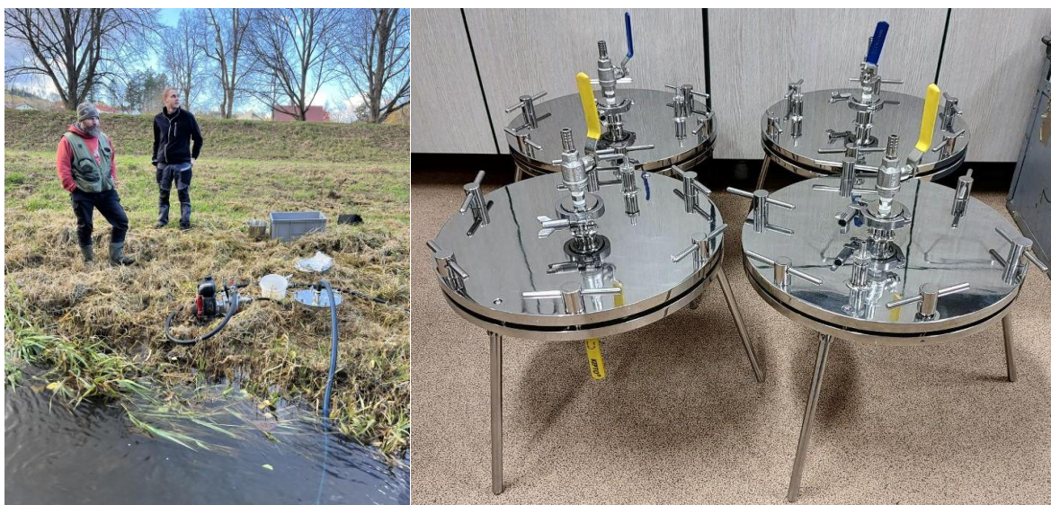
Obr. 4. Čerpání a filtrace vody z proudnice k analýze obsahu mikroplastů (vlevo); detail filtrační aparatury (vpravo)
