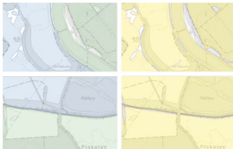
Obr. 7. Příklady spojení hranic polygonů mezi oblastmi A a B Fig. 7. Examples of polygon boundary merging between areas A and B
