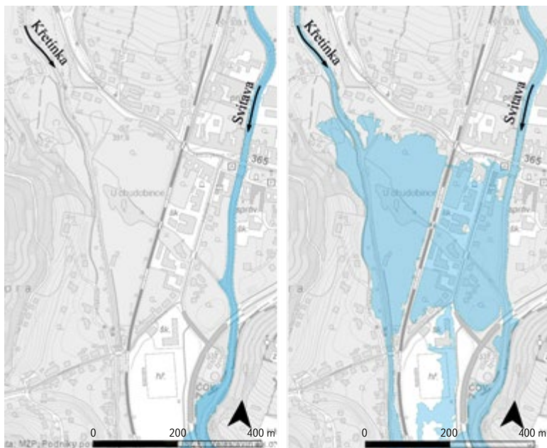
Obr. 10. Soutoková oblast Svitava – Křetínka při scénáři Q_{20} ; vlevo bez vlivu soutoku [6], vpravo se soutokem
