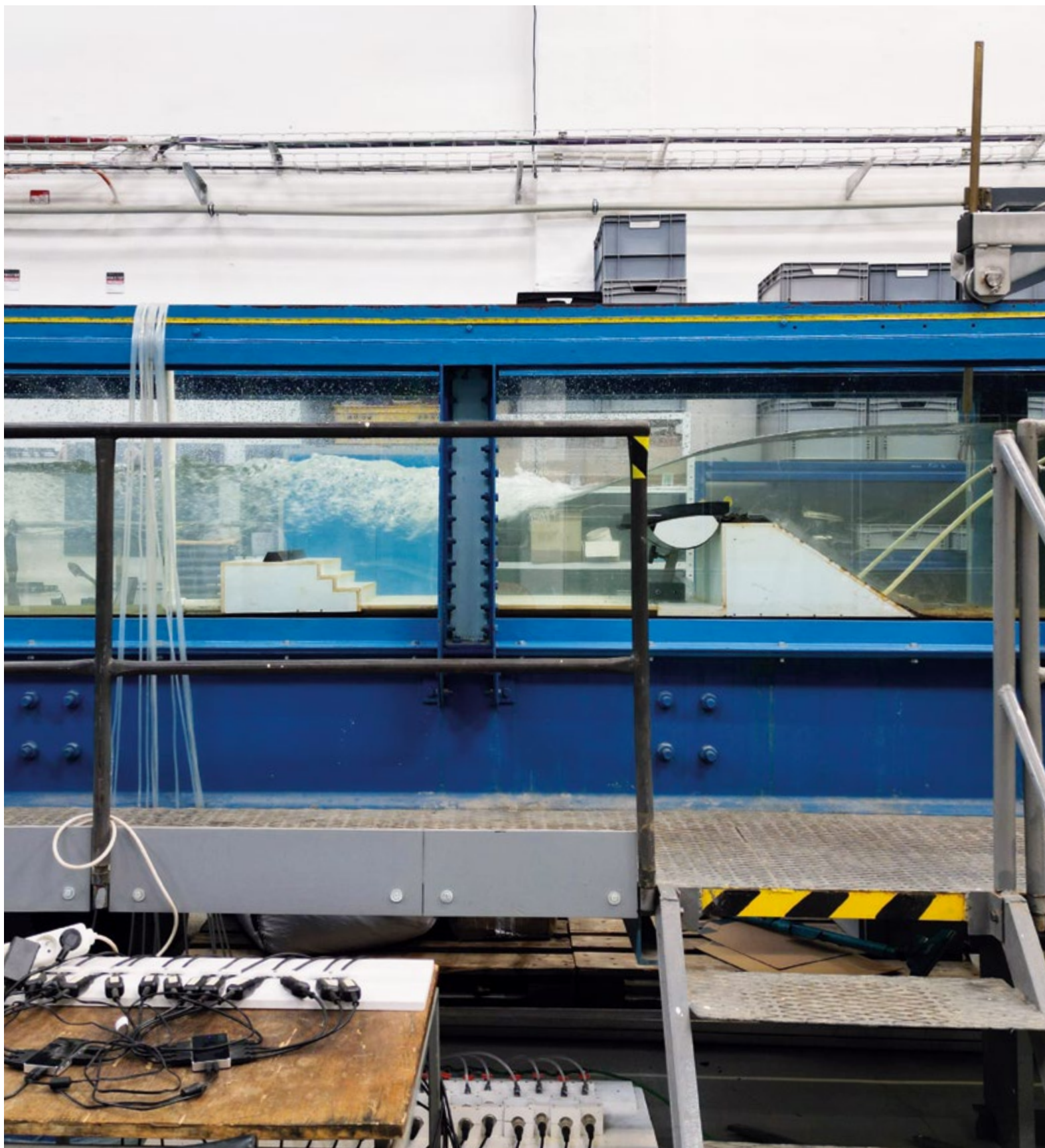
Obr. 3. Fyzikální model jezu Doksany Fig. 3. Physical model of Doksany weir
