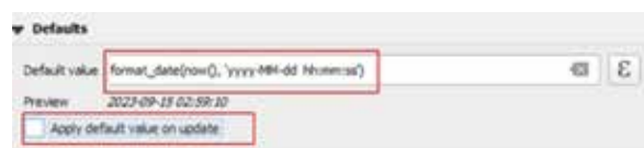
Obr. 10. Příklad konfigurace výchozí hodnoty – časové razítko Fig. 10. Default value configuration example – timestamp
