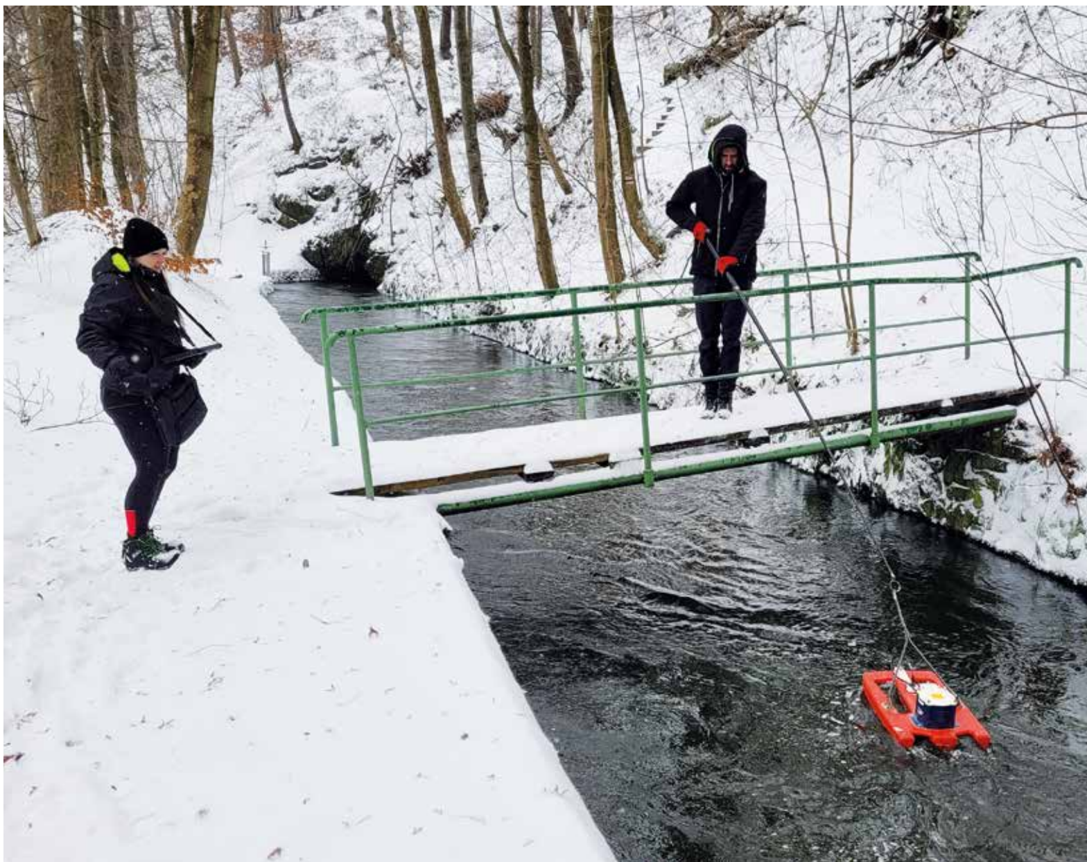
Obr. 1. Měření průtoků pomocí ADCP přístroje RDI StreamPro na Weissshuhnově náhonu v Žimrovicích dne 8. ledna 2024 (Foto: J. Unucka) Fig. 1. Discharge measurement using ADCP RDI StreamPro, Weissshuhn flume in Žimrovce, 8th January 2024 (Photo: J. Unucka)
