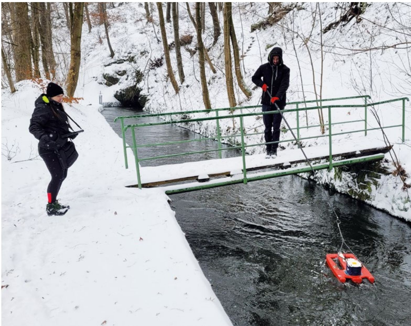
Obr. 1. Měření průtoků pomocí ADCP přístroje RDI StreamPro na Weissshuhnově náhonu v Žimrovicích dne 8. ledna 2024 (Foto: J. Unucka) Fig. 1. Discharge measurement using ADCP RDI StreamPro, Weissshuhn flume in Žimrovice, 8th January 2024 (Photo: J. Unucka)
