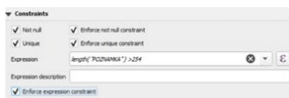
Obr. 9. Omezení hodnot atributu Fig. 9. Restriction of attribute values
