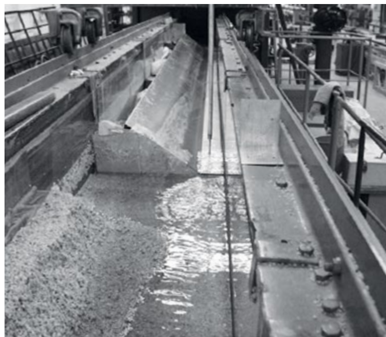
Obr. 2. Úplný prostorový model koryta v přechodové oblasti vývoje výmolu (vlevo); poloviční model koryta s osou symetrie ve skleněné stěně žlabu (vpravo) – vše v laboratorních podmínkách
