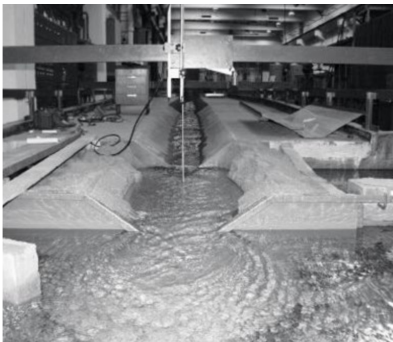
Obr. 2. Úplný prostorový model koryta v přechodové oblasti vývoje výmolu (vlevo); poloviční model koryta s osou symetrie ve skleněné stěně žlabu (vpravo) – vše v laboratorních podmínkách
