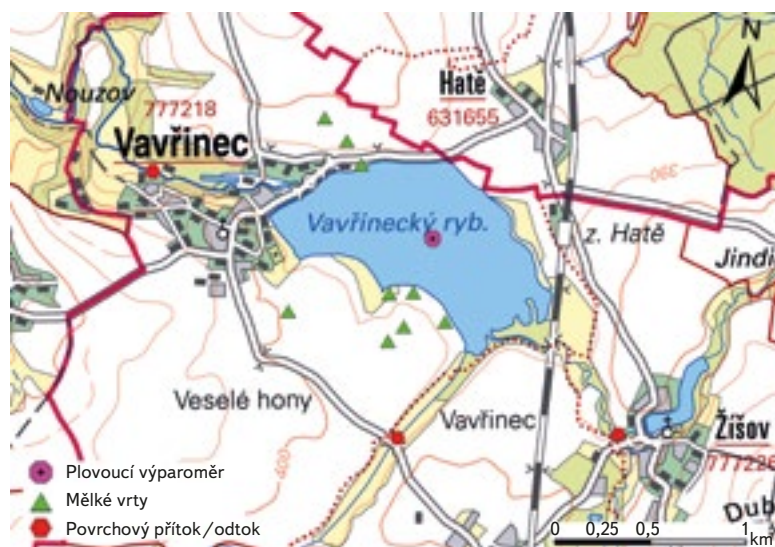
Obr. 2. Umístění monitorovacích čidel na Vavřineckém rybníce Fig. 2. Monitoring placement at Vavřinec pond
