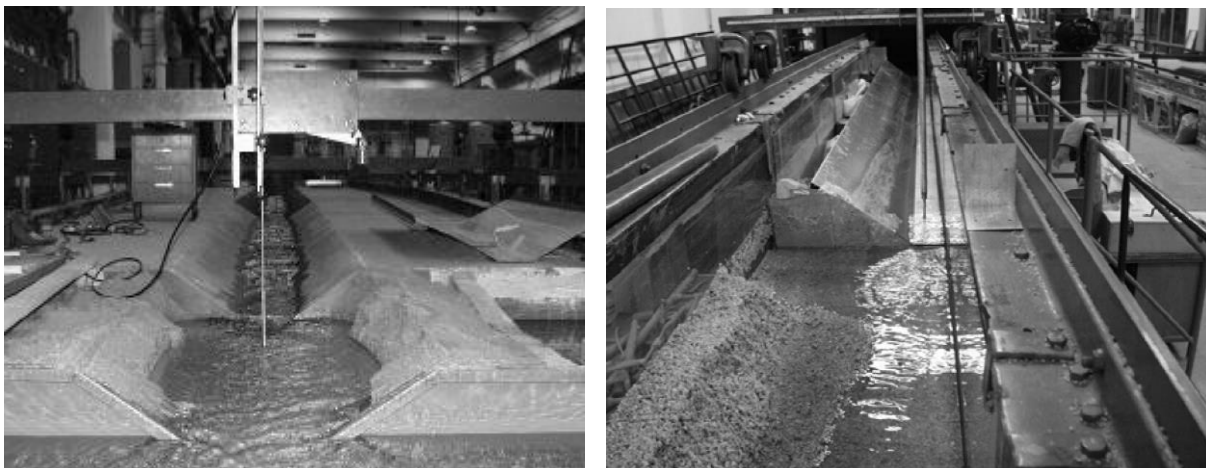
Obr. 2. Úplný prostorový model koryta v přechodové oblasti vývoje výmolu (vlevo); poloviční model koryta s osou symetrie ve skleněné stěně žlabu (vpravo) – vše v laboratorních podmínkách
