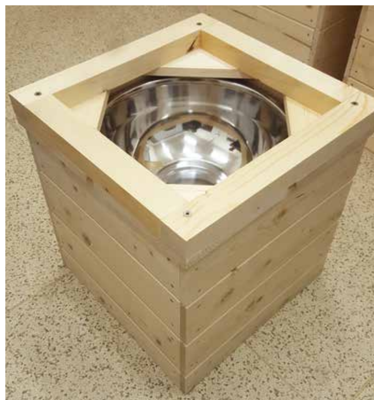
Obr. 4. Srážkoměr pro zachycení srážek pro analýzu PAU Fig. 4. The rain gauge for precipitation capture for PAH analysis
