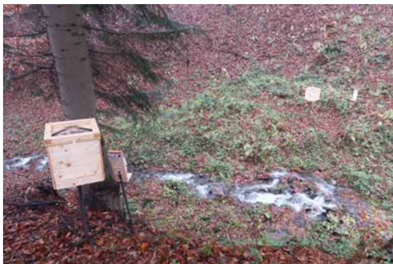
Obr. 5. Srážkoměry pro zachycení srážek typu bulk a throughfall na lokalitě Bystřice (5. listopad 2020)
