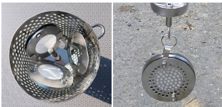
Obr. 5. Pasivní vzorkovač typu POCIS ve velkém koši (vlevo) a v chráničce (vpravo) Fig. 5. Passive sampler POCIS in big canister (left) and in the casing (right)
