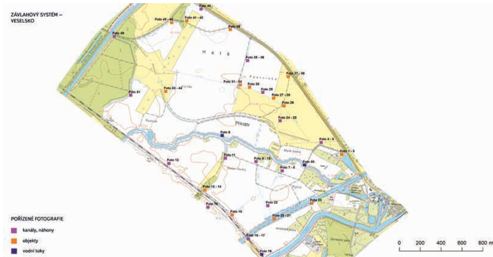
Obr. 2. Příklad zpracování lokalizace jednotlivých objektů a vybraných důležitých prvků závlahového systému v okolí Veselí nad Moravou na základě aktuálních terénních průzkumů, podklad ZABAGED®
