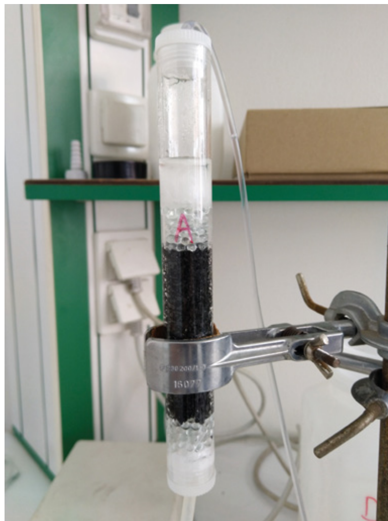
Obr. 2. Foto skleněné kolonky s GAU během testování pomocí RSSCTs (autor: Anna Kólová)
