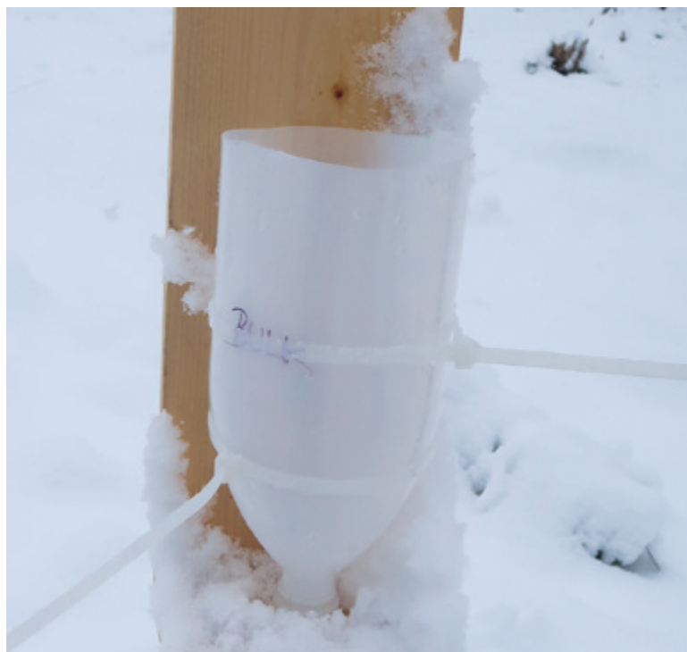
Obr. 4. Nádoba na zachycení srážek typu bulk pro analýzu kovů v pilotním území Košetice (vlevo: stav 6. listopadu 2020, vpravo: stav 7. ledna 2021)
