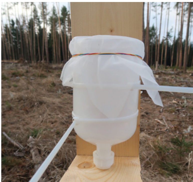
Obr. 4. Nádoba na zachycení srážek typu bulk pro analýzu kovů v pilotním území Košetice (vlevo: stav 6. listopadu 2020, vpravo: stav 7. ledna 2021) Fig. 4. Bulk precipitation sampling in Košetice pilot locality (left: state 6 November 2020, right: state 7 January 2021)
