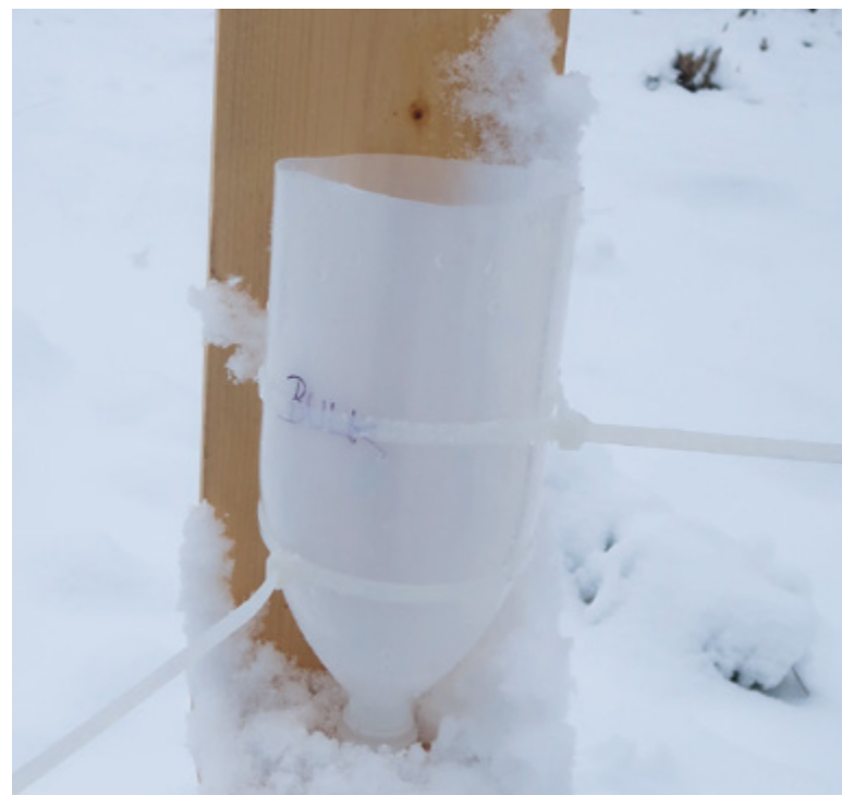
Obr. 4. Nádoba na zachycení srážek typu bulk pro analýzu kovů v pilotním území Košetice (vlevo: stav 6. listopadu 2020, vpravo: stav 7. ledna 2021) Fig. 4. Bulk precipitation sampling in Košetice pilot locality (left: state 6 November 2020, right: state 7 January 2021)
