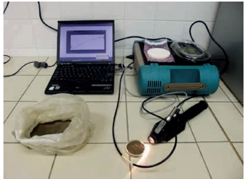
Obr. 1. Spektrometr FieldSpec 3 (foto: Josef Kratina)
