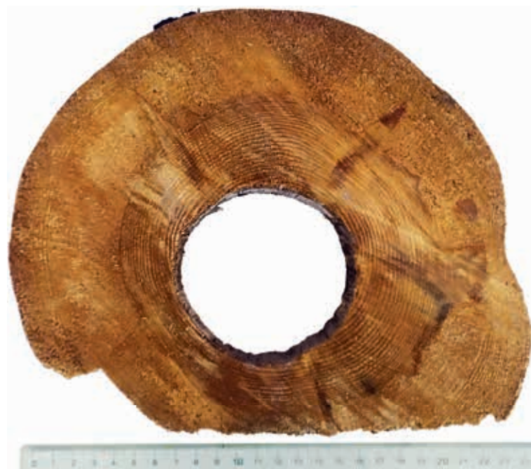
Obr. 2. Detail vzorku z jedlového potrubí šumperského vodovodu (Šperlichová M., červenec 2021)
