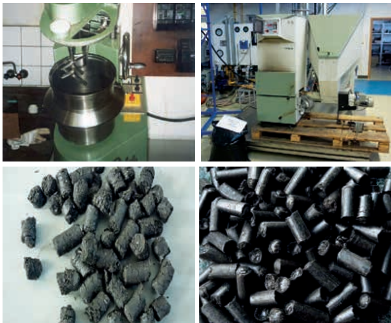
Obr. 3. Fotodokumentace – alternativní vícesložkové palivo na bázi odpadů, upravených na zařízení pro fyzikální úpravu odpadů podle EP 2388068 „Device for physical waste treatment“ – homogenizace složek před granulací ve spolupráci s VÚHU a. s., Most, spalné zkoušky na certifikovaném testovacím zařízení VŠB – TUO v Ostravě, ukázky finálního granulovaného vícesložkového tuhého alternativního paliva
