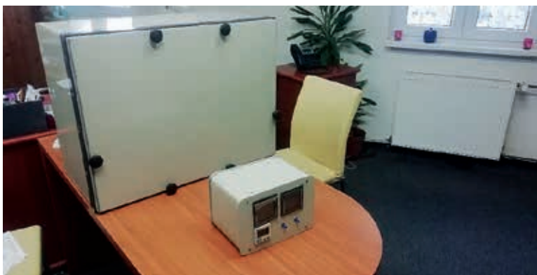
Obr. 4. Elektrický rozvaděč pro navýšený zdroj VN, řídicí jednotka pro elektrostatické pole
