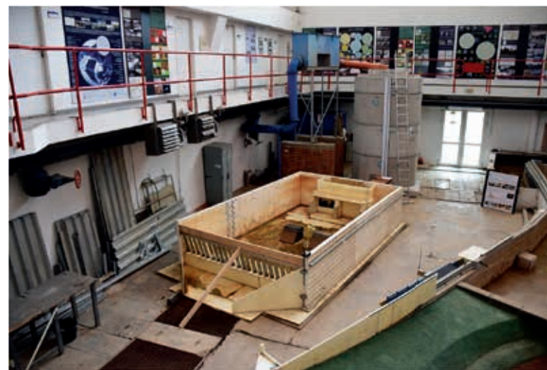
Obr. 1. Rozsah modelu spodní výpusti a fotografie vlastního provedení modelu spodní výpusti
