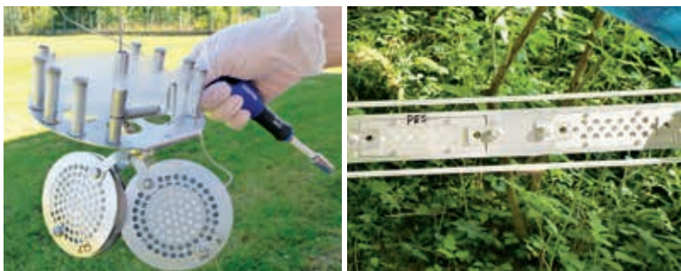
Obr. 3. Membrány: SR (vlevo nahoře), POCIS (vlevo dole), POCIS mini (vpravo) Fig. 3. Membranes: SR (left up), POCIS (left down), POCIS mini (right)
