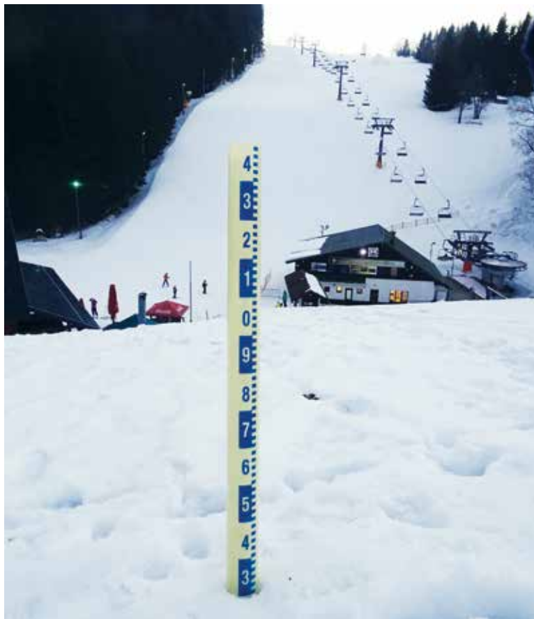
Obr. 11. Měření vodní hodnoty sněhu pomocí sněhoměru ve Vítkovici Fig. 11. Measurement of water value of snow using snow meter in Vítkovice
