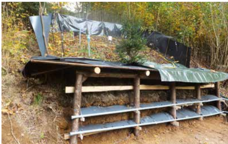
Obr. 3. Experiment na louce, Dolní Lučany, drážky 20 a 50 cm od povrchu Fig. 3. Experiment on the meadow, Dolní Lučany, troughs 20 and 50 cm from the surface
