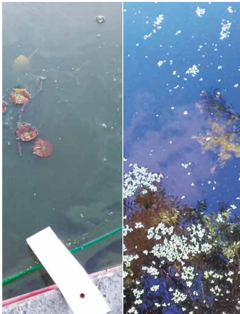
Obr. 7. Rozdíl mezi průhledností vody nádrže bez aplikace biopreparátu (vlevo, sinicový vodní květ) a s aplikací biopreparátu během vegetační sezony (vpravo)
