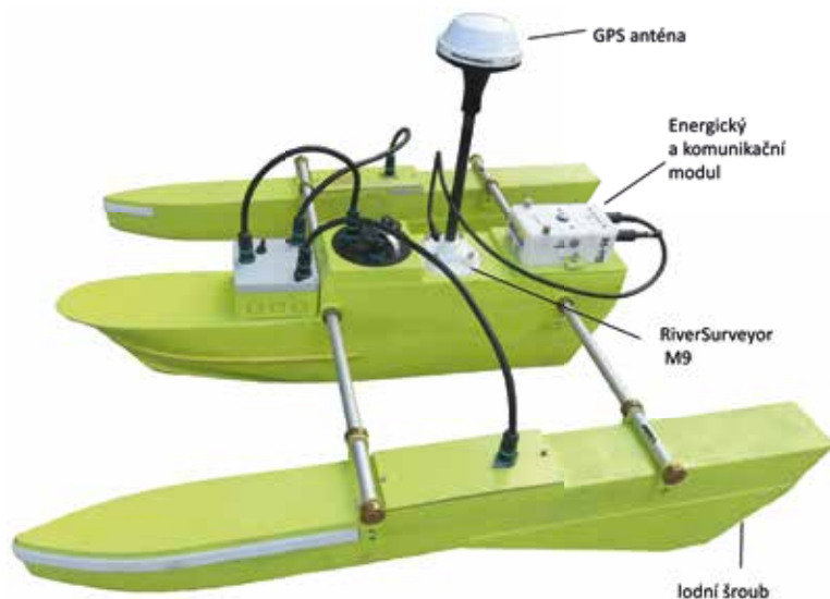
Obr. 4. Konstrukční provedení plavidla trimaran Fig. 4. Trimaran design
