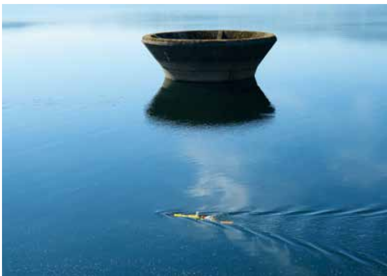
Obr. 8. EcoMapper při batymetrické misi v blízkosti sdrúženého objektu Fig. 8. EcoMapper on a bathymetric mission near a clustered object
