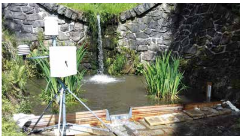
Obr. 3. Vodoměrná stanice s pozorováním srážek a teploty vzduchu, lokalita Novoveský potok (přítok Račinky v Žárové)
