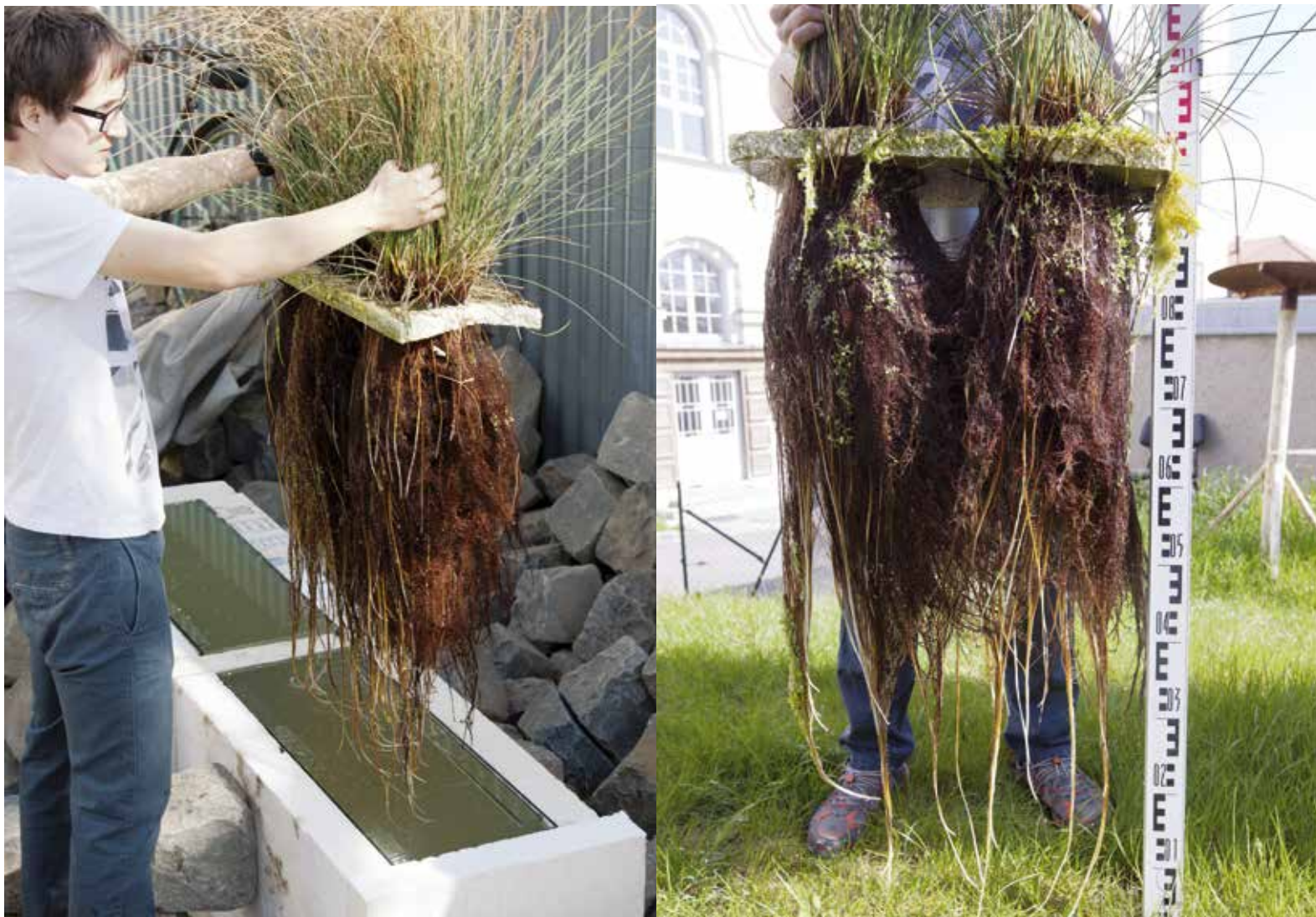
Obr. 4. Laboratorní pokusy pro stanovení účinnosti kořenového systému rostlin na zlepšení jakosti vody
