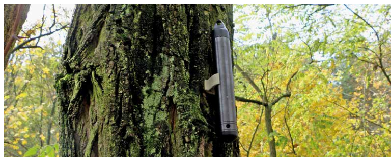
Obr. 6. Čidlo Solinst Barologger 3001 firmy určené pro kompenzaci hydrostatického tlaku na tlak vzduchu
