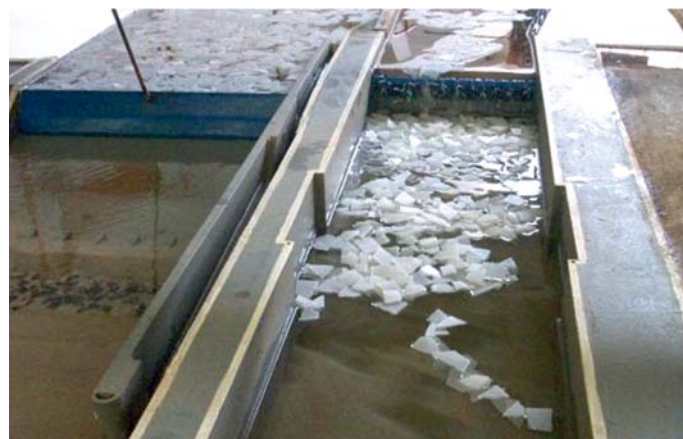
Obr. 3. Hromadění ledů při Q = 117 \text{ m}^3 \cdot \text{s}^{-1} Fig. 3. Ice cumulation at Q = 117 \text{ m}^3 \cdot \text{s}^{-1}
