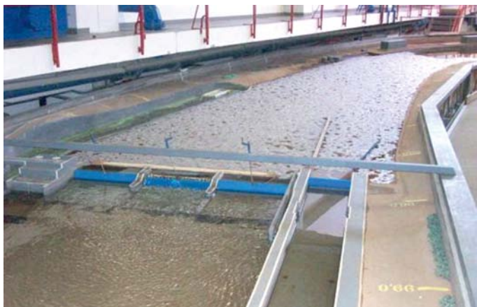
Obr. 7. Horní zdrž naplněná krami Fig. 7. The upper basin filled with ice floe
