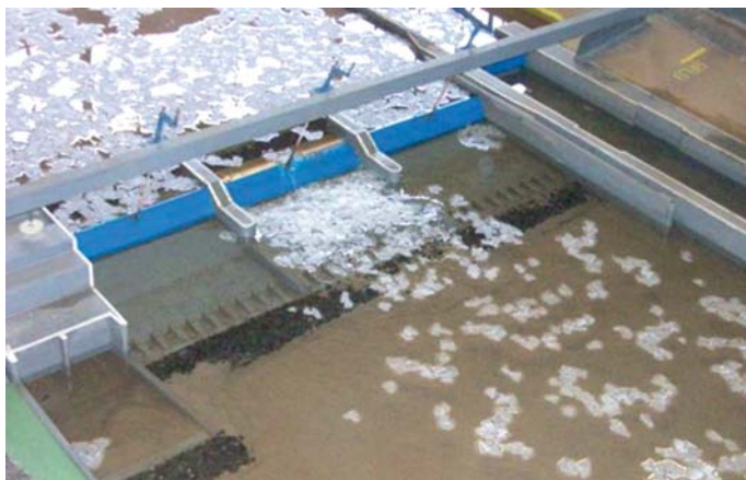
Obr. 9. Transport ledů středním jezovým polem Fig. 9. Middle weir section ice transportation
