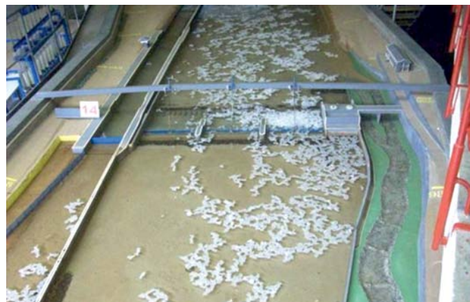
Obr. 10. Převádění ledů při Q = 633 \text{ m}^3 \cdot \text{s}^{-1} Fig. 10. Ice transportation at Q = 633 \text{ m}^3 \cdot \text{s}^{-1}
