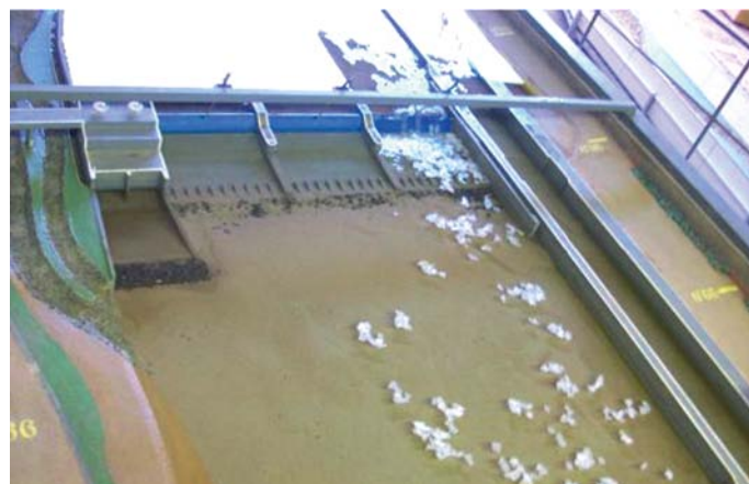
Obr. 4. Transport ledů levým jezovým polem Fig. 4. Left weir section ice transportation
