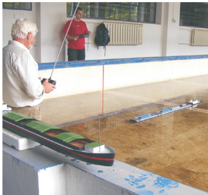
Obr. 4. Kalibrace tlačného soulodí TR + 1,5 TČ Fig. 4. Push tug model TR + 1,5 TČ calibration
