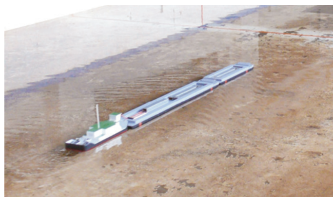
Obr. 3. Model tlačného soulodí TR + 1,5 TČ
