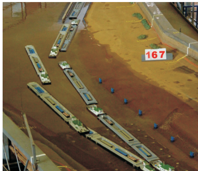
Obr. 14. Potkávání se dvou tlačných soulodí u čekacího stání pravobokem při průtoku Q = 690 \text{ m}^3 \cdot \text{s}^{-1} Fig. 14. Encountering two push tugs at waiting point by right-side by discharge Q = 690 \text{ m}^3 \cdot \text{s}^{-1}
