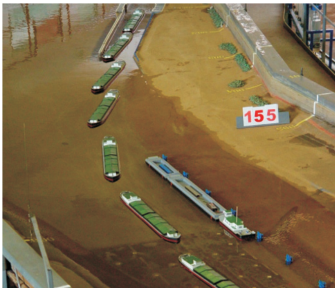
Obr. 13. Plavba MNL 11600 po proudu při průtoku Q = 690 \text{ m}^3 \cdot \text{s}^{-1} , v místě čekacího stání vyvázané tlačné soulodí Fig. 13. Motor cargo ship downstream navigation by discharge Q = 690 \text{ m}^3 \cdot \text{s}^{-1} , push tug at waiting point
