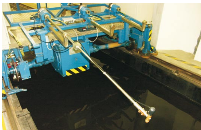
Obr. 2. Elektromagnetické měřidlo připravené ke kalibraci Fig. 2. Electromagnetic flow meter prepared for calibration
