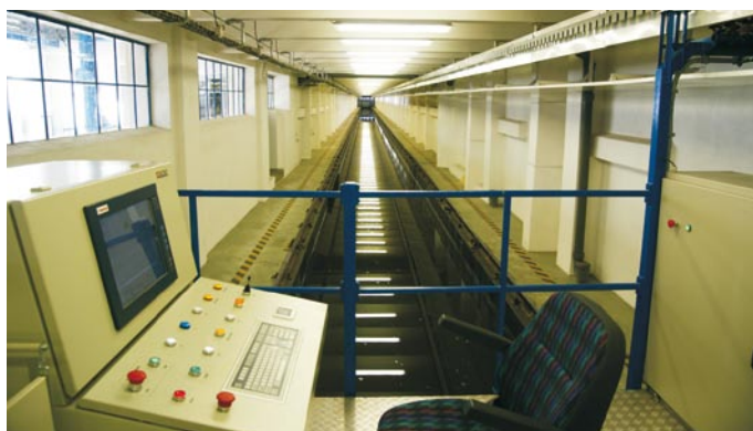
Obr. 1. Průhled do kalibračního žlabu s kalibračním vozíkem Fig. 1. View of calibration tank with the trolley
