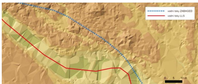
Obr. 1. Vodní tok ZABAGED® a vykreslení osy toku v datech LLS – pro koryto typu 1
