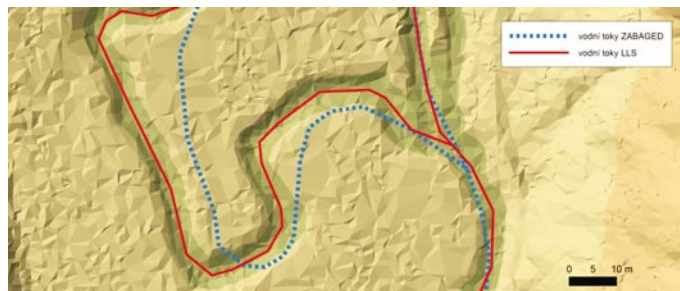
Obr. 2. Vodní tok ZABAGED® a vykreslení osy toku v datech LLS – pro koryto typu 2
