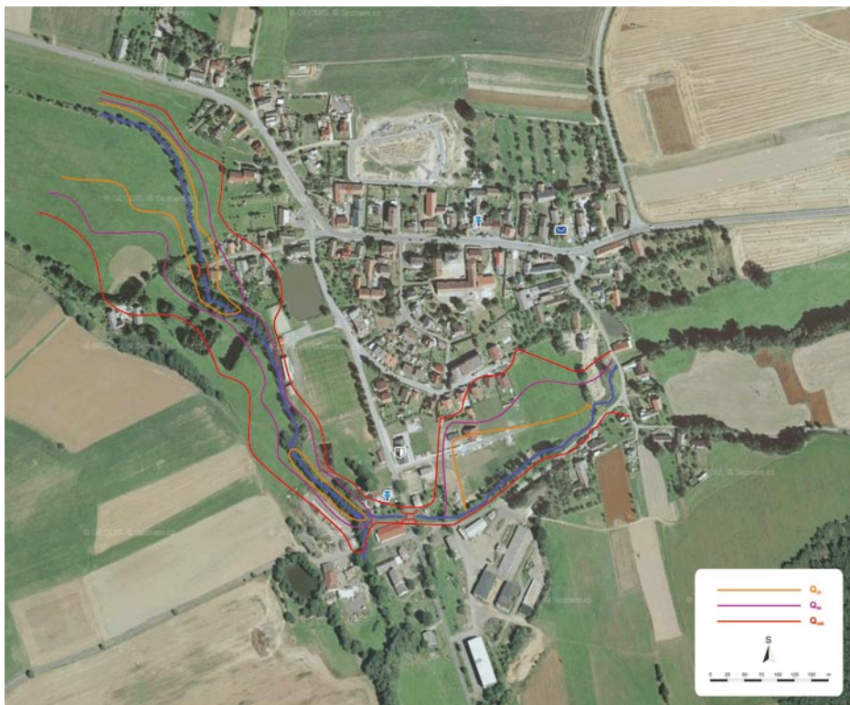
Obr. 2. Vytyčení záplavového území Fig. 2. Scheme of floodplain
