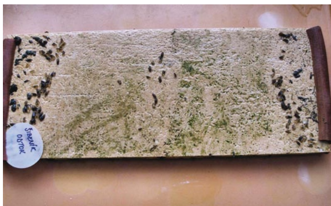
Obr. 3. Dlaždice s nárostem opatřená gumovými koncovkami Fig. 3. Overgrown floor tile with rubber plugs
