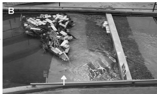
Obr. 2. Konstruktivní řešení lapače splávků z předsunutých „bárek“ (A) jako ochrana mostního objektu před zátarasy z plovoucích předmětů při povodních a ukázka výsledného efektu aplikace sady ochranných bárek (B, řada bárek označena šipkou) při modelování povodňové situace na fyzikálním modelu
