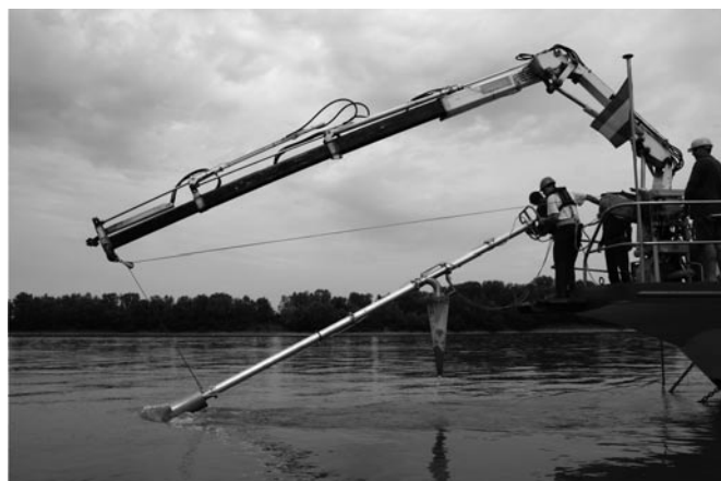
Obr. 2. Odběr makrozoobentosu pomocí air-liftu
