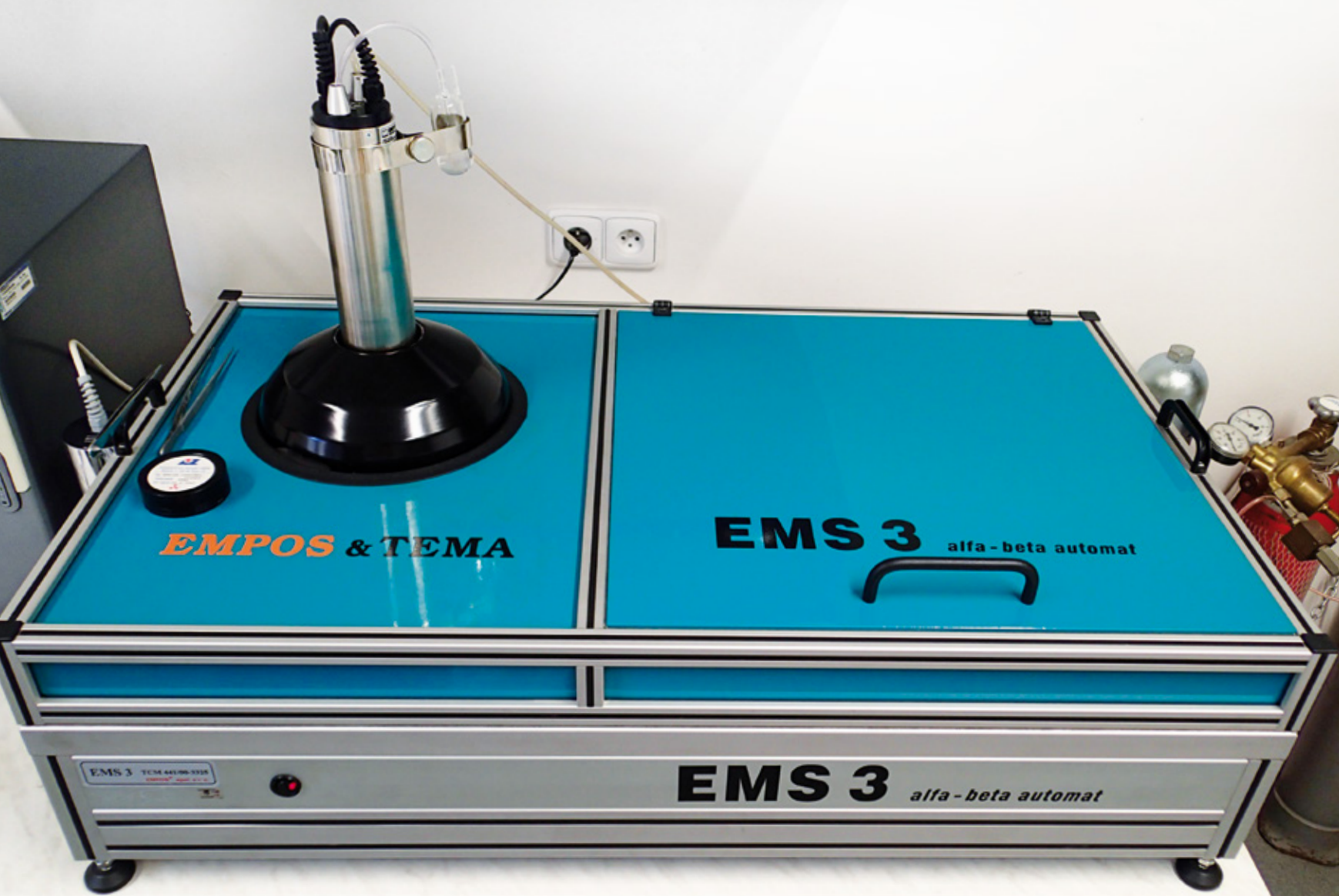
Alfa, beta automat EMS-3 použitý k ověření metody stanovení celkové objemové aktivity beta rychlou metodou ve VÚV TGM, v. v. i.
