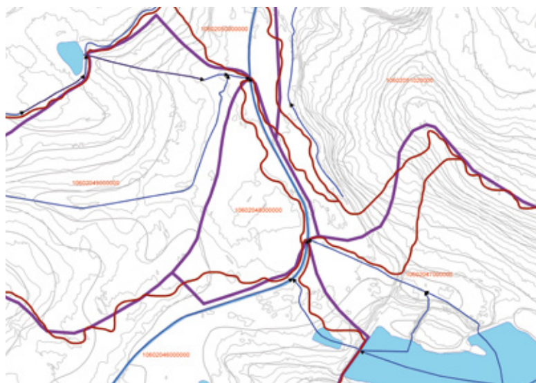
Obr. 5. Příklad rektifikace rozvodnic v důsledku využití výsledků leteckého laserového skenování reliéfu; fialová křivka značí stav; červená křivka značí změnu Fig. 5. The Watersheds Spatial Data Rectification; red colour shows the new position
