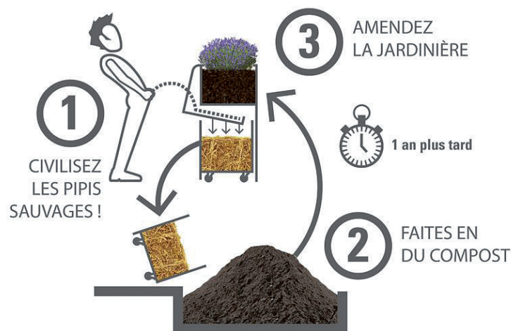
Obr. 1. Suchý veřejný pisoar ve Francii – schéma [2]
