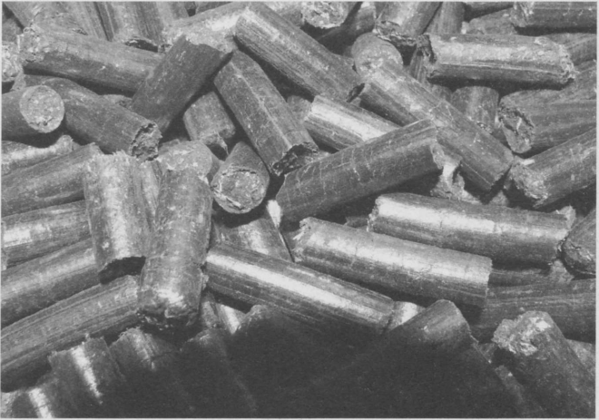
Obr. 2. Peleta ze vzorku připraveného homogenizací upraveného kalu z ČOV, biomasy (obilná sláma) a hnědého uhlí
