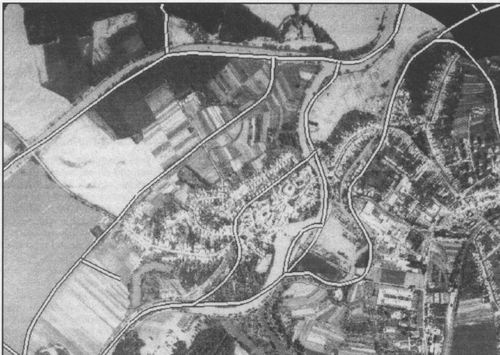
Obr. 1. Výřez ortofotosnímku kombinovaný s vektorovou linií osy toku tak, jak byla zdigitalizována ze Základní VH mapy
