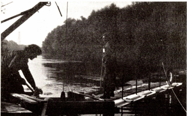
Obr. 2: Opět profil Lhotka. Plovoucí pochůzná norná stěna a záchytná jímka s odlučovačem (visí na laně pro možnost změny jeho ponoření). Na hladině je vidět simulované ropné znečištění - řezanka ze slámy.
