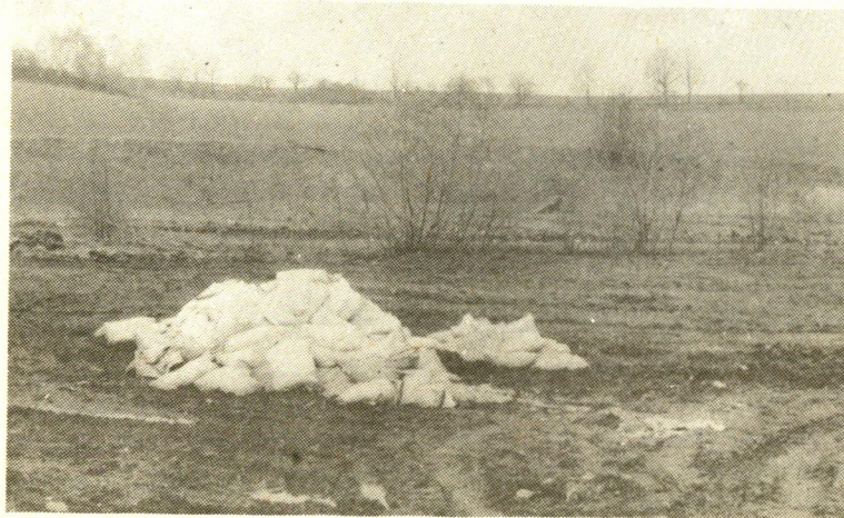
Obr. 2 Příklad špatného skladování vlnustého lečivového vápna /lokalita Zdíkov v Kašperských Horách/
