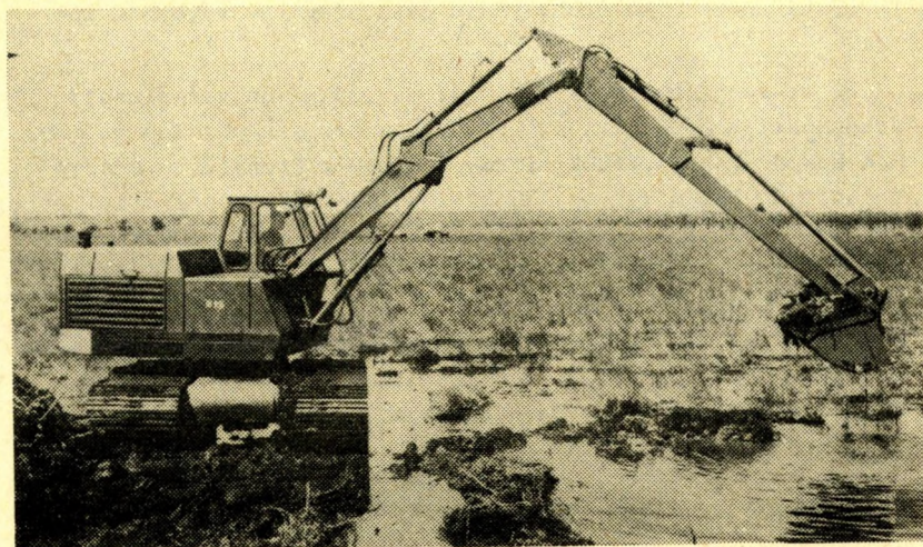
Obr.7. Bagr TC 45 pracuje v bažinatém terénu.
