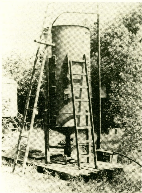
Zařízení pro zjišťování kolmatace instalované na lokalitě Velké Žernoseky u Litoměřic
