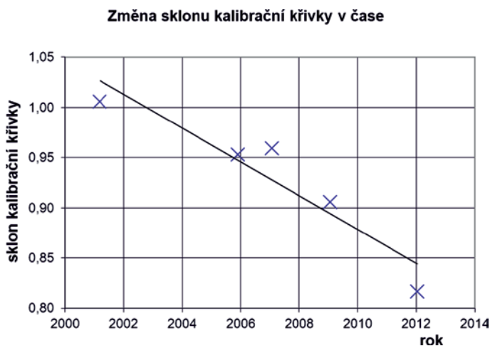
Obr. 1. Změna sklonu kalibrační křivky elektromagnetického měřidla v čase
